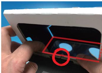
⑦ 装着するスマートフォンは液晶面が内側(筐体側)に、アウトカメラが左側(上図参照)に来るようにします。
