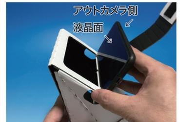
⑦ 装着するスマートフォンは液晶面が内側(筐体側)に、アウトカメラが左側(上図参照)に来るようにします。
