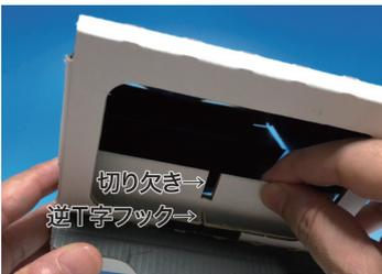
⑥ レンズ固定台紙を引き寄せたら、筐体(外箱)全体の骨格を補強するようなイメージ(=上図□印)で固定台紙の切り欠きと筐体側の逆T字フックを上図○印のように噛み合わせます。接着剤やマジックテープで固定しませんが筐体全体がしっかり自立するようになります。
